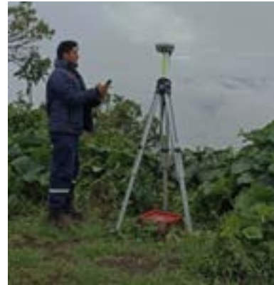
Trabajos de topografía a lo largo de red de conducción del sistema de riego
