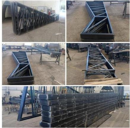
**Fabricación de estructuras metálicas**
